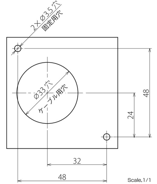
※ ネジ止めの場合は、呼び径 3 又は M3 を使用してください。
