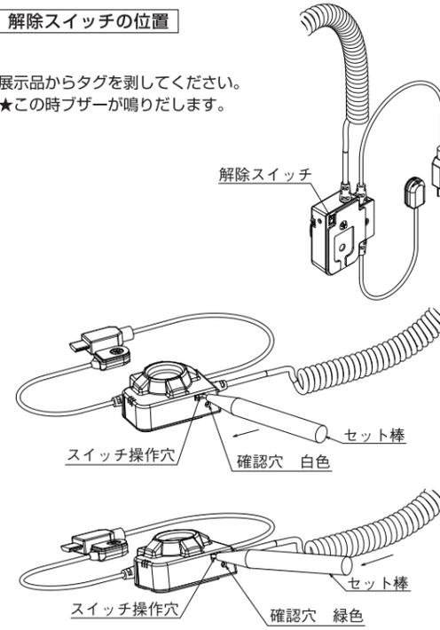
本体タグの裏面にある解除スイッチを押しながら、スライドスイッチを ON から OFF の位置へ動かしてください。
