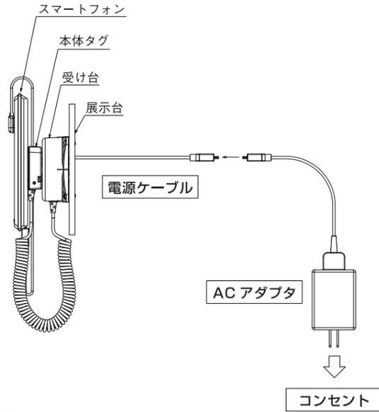
⚠️ スマートフォンは 5V、1A までの AC アダプタが付属された機器への電力供給を上限としますのでご注意ください。
