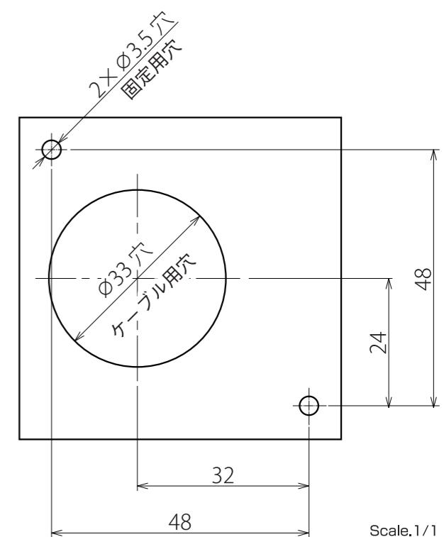
\* ネジ止めの場合は、呼び径 3 又は M3 を使用してください。
