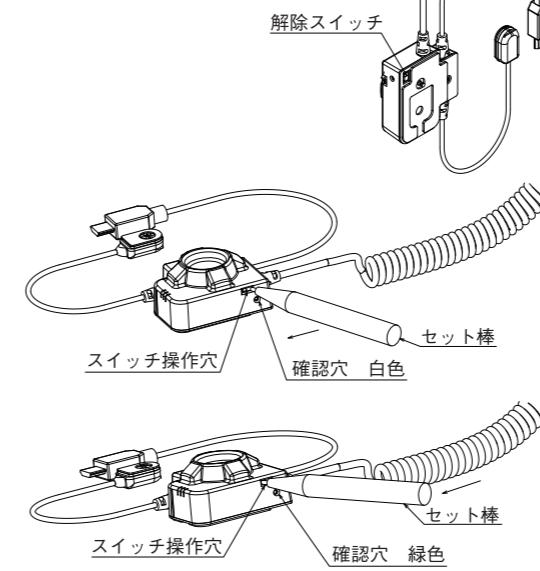
本体タグの裏面にある解除スイッチを押しながら、スライドスイッチを ON から OFF の位置へ動かしてください。
